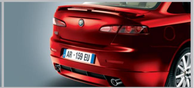
Dam e spoiler posteriore, terminale di scarico
