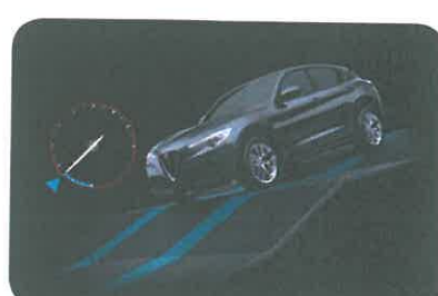
System kontroli zjazdu
