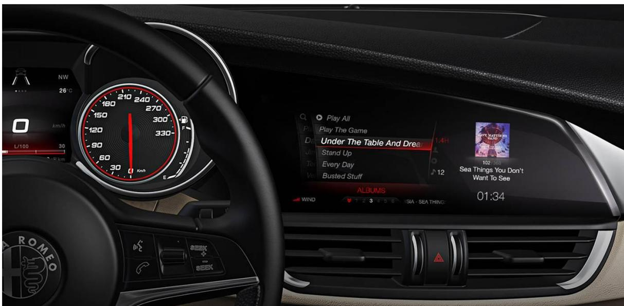
Il display è utilizzato dal modulo ETM come interfaccia a disposizione dell'utente della vettura per gestire i contenuti infotelematici e di comfort della vettura.
