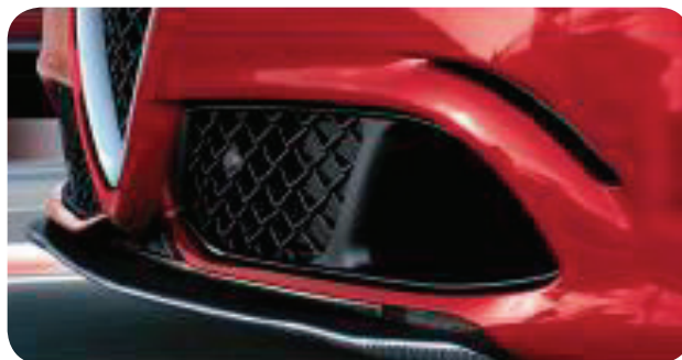
Aero Splitter – dolny spoiler dociskowy wysuwany przy prędkości 100 km/h
