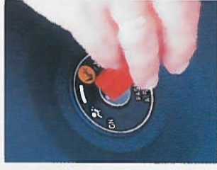
Jeśli z przodu zamontujemy fotelik dla dziecka, poduszka powietrzna może zostać „wyłączona” za pomocą kluczyka.
