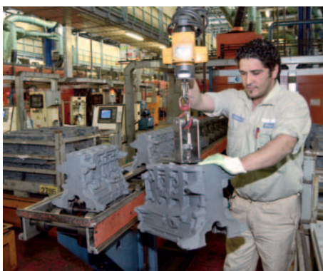
Transport bloków silnika
